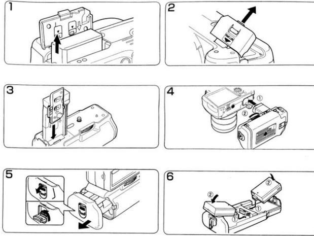
3. Schutzkappe entfernen und Batteriefach an Battery Grip befestigen (Fig.7-1). Nach Befestigung, bitte überprüfen ob Batteriefach sicher festgemacht wurde.
