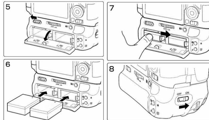
1. Schieben Sie den Schalter und öffnen Sie die Batteriefachabdeckung in der Richtung des Pfeiles (Abbildung 5)
